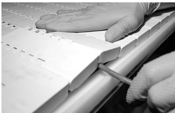
Figur 88: Böj pinnen en aning och för in den genom gångjärnen
