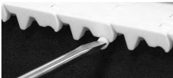
Figur 174: Tryck pinnen förbi spärranordningen
