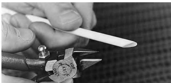
Figur 14: Klipp pinne i en vinkel
