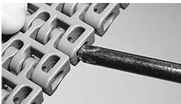
Figur 145: Tryck pinnen förbi spärranordningen
