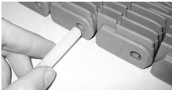
Figur 215: För in pinnen genom gångjärnen
