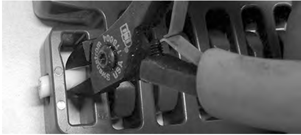
Figur 333: Tryck pinnen åt sidan och förbi det tillslutna hålet
