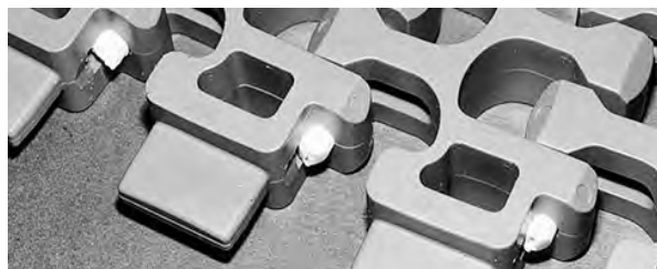
Figur 272: Se till att pinnen är helt insatt.
