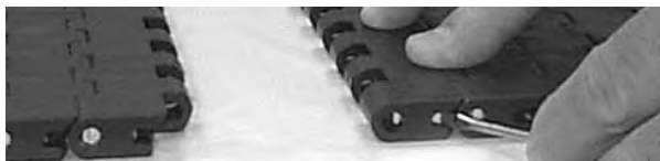
Figur 160: Använd en skruvmejsel för att stänga Slidelox
