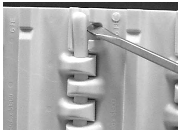
Figur 206: Lyft pinnen över spärranordningen
