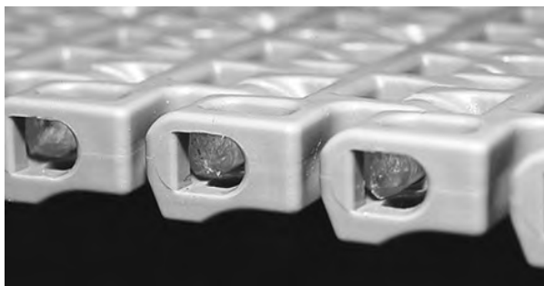
Figur 146: Se till att pinnens läge är förbi spärranordningen
