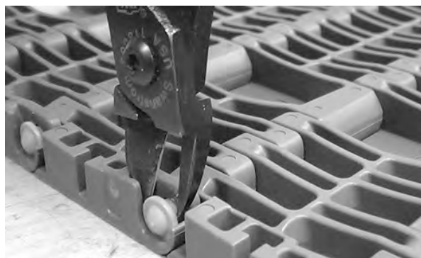
Figur 268: Klipp av kantpinne
