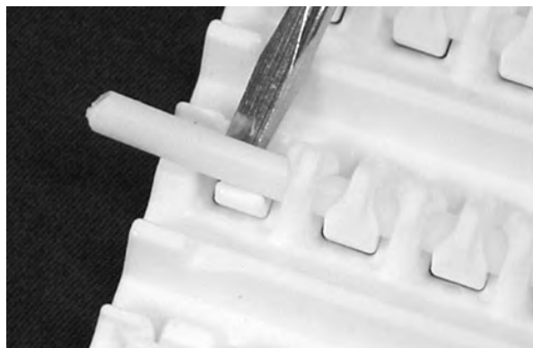
Figur 176: Lyft pinnen över spärranordningen
