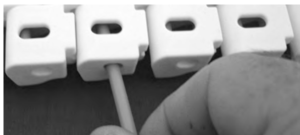
Figur 282: För in pinnen genom gångjärnen
