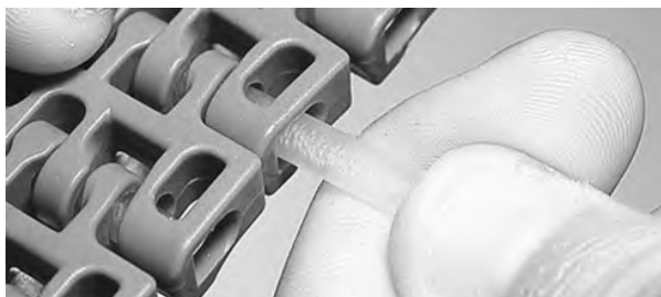
Figur 135: För in pinnen genom gångjärnen
