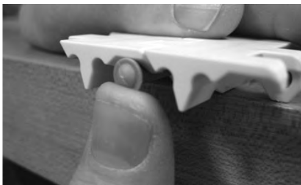
Figur 179: Använd tummen för att trycka på pinnhuvudet
