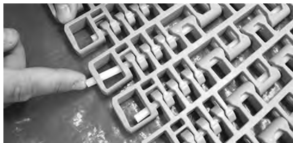
Figur 338: Tryck pinnen förbi spärranordningen
