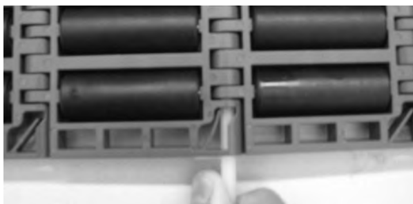
Figur 236: För in pinnen genom gångjärnen
