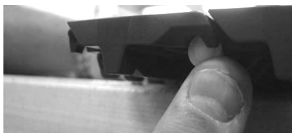
Figur 69: Tryck pinnen förbi spärranordningen
