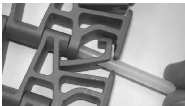
Figur 246: För in pinnen genom gångjärnen
