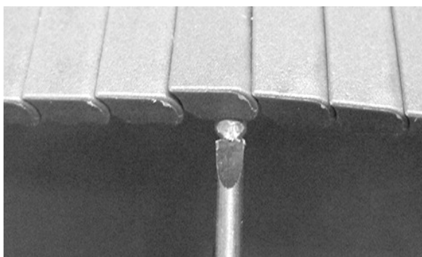
Figur 54: Tryck pinnen förbi spärranordningen
