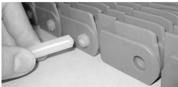
Figur 216: Tryck pinnen förbi Shuttleplug
