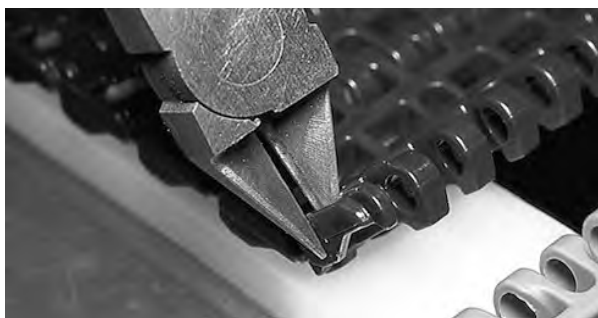
Figur 140: Klipp av halva kanten
