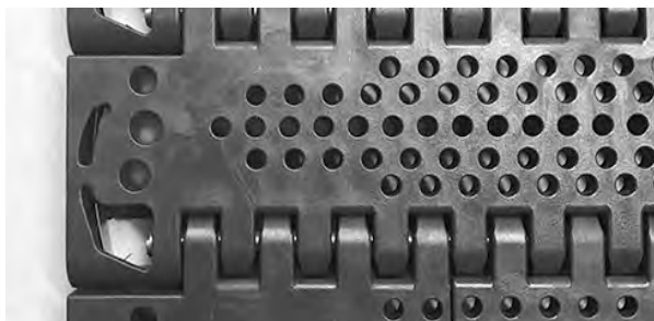
Figur 108: Se till att pinnen är helt insatt.
