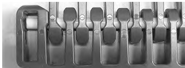
Figur 332: Se till att pinnens läge är förbi spärranordningen
