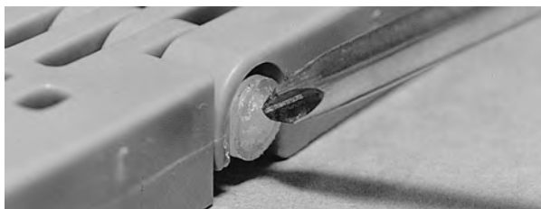
Figur 38: Se till att pinnens huvud sitter utanför snäpplåset
