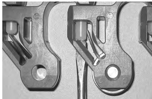
Figur 300: Skjut pinnen förbi spärranordningen
