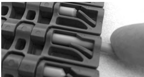
Figur 127: För in pinnen genom gångjärnet
