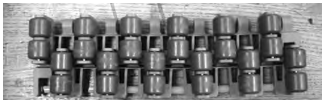
Figur 189: Montera med två rader åt gången
