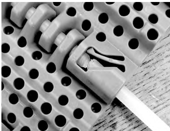
Figur 85: Skjut pinnen förbi spärranordningen
