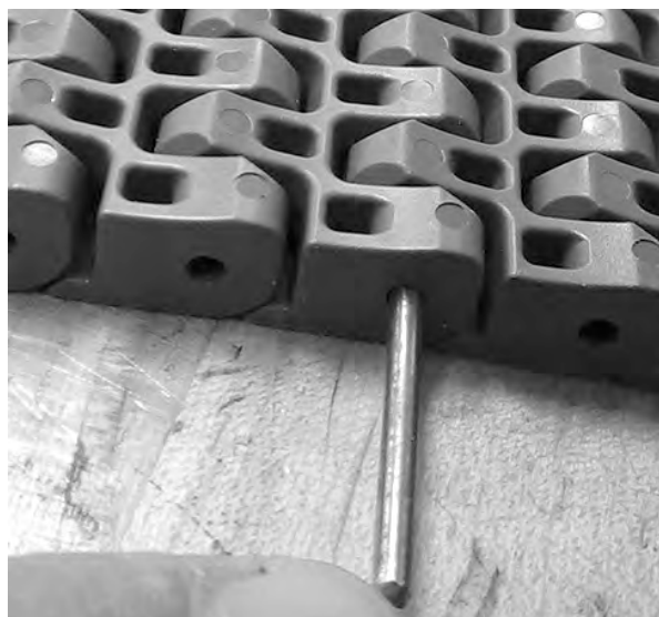
Figur 269: Skjut ut pinnen och kantpinnen ur bandet
