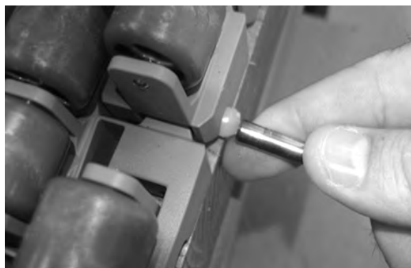
Figur 190: Skjut pinnen förbi spärranordningen
