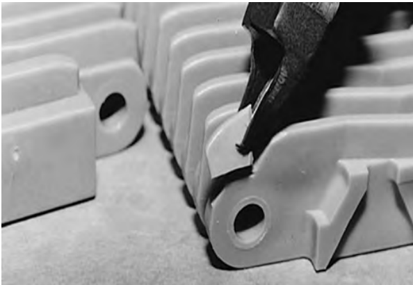
Figur 47: Klipp av den yttersta ribban
