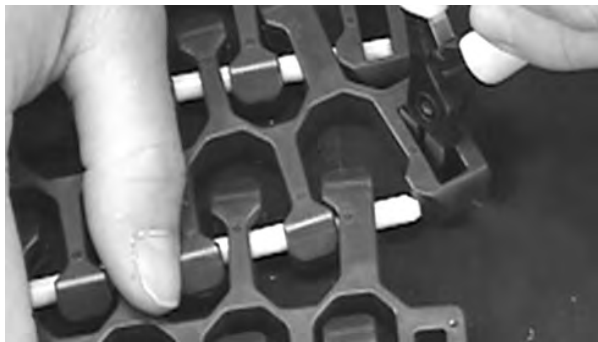
Figur 310: Böj modulens jämna kant för att frigöra pinnen
