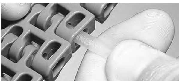
Figur 144: För in pinnen genom gångjärnen
