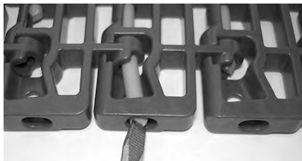
Figur 123: Tryck pinnen förbi spärranordningen
