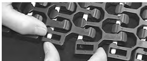
Figur 307: Skjut pinnen förbi bandkanten och snäpp den plana kanten över pinnen
