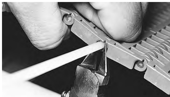
Figur 113: Klipp av pinnen plant mot bandets kant
