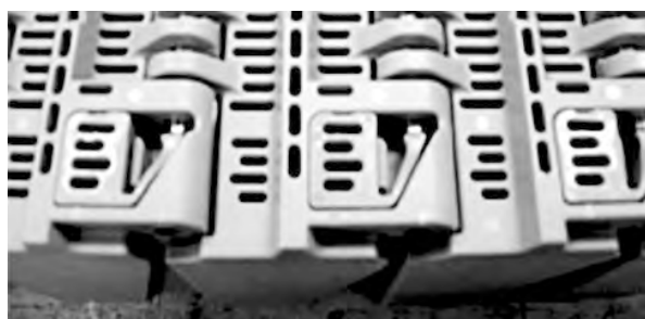
Figur 105: Se till att spärranordningen är stängd
