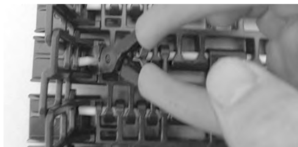
Figur 367: Tryck pinnen förbi spärranordningen
