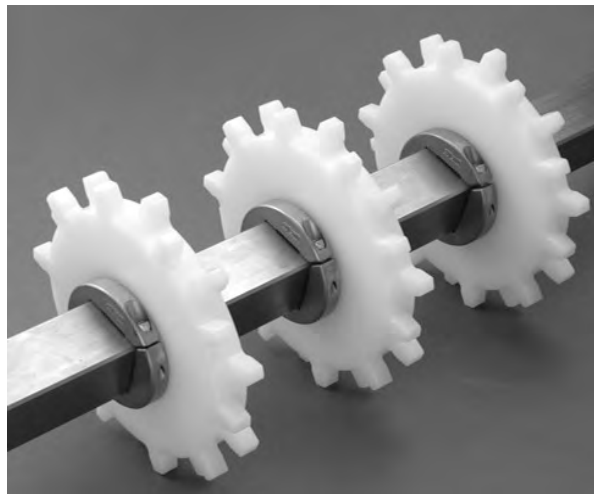
Figur 318: Sätt fast båda sidor av alla tandhjul
