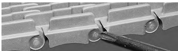
Figur 23: Se till att pinnens huvud sitter utanför snäpplåset
