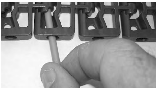
Figur 122: För in pinnen genom gångjärnen
