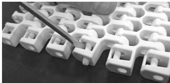
Figur 290: Tryck pinnen genom spärranordningen
