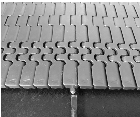
Figur 59: Skjut pinnen förbi spärranordningen
