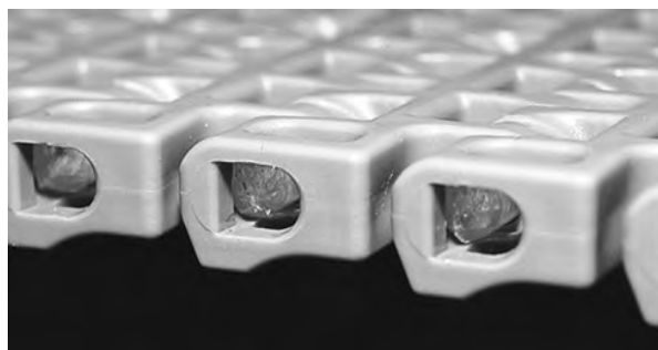
Figur 137: Tryck pinnen förbi spärranordningen
