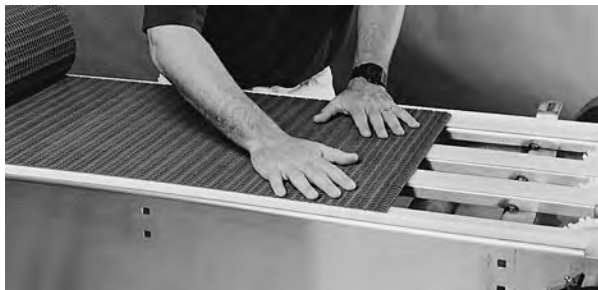
Figur 8: Mata bandet från drivänden
