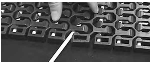
Figur 304: För in pinnen genom gångjärnen
