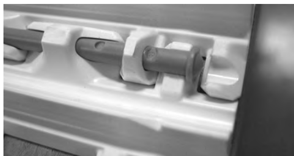
Figur 181: Se till att pinnen är helt insatt
