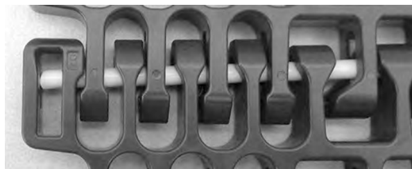
Figur 315: Se till att pinnens läge är förbi spärranordningen
