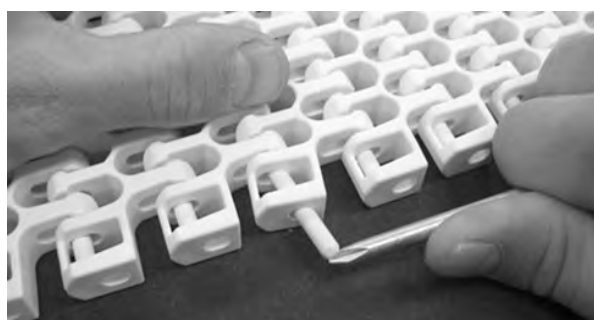
Figur 288: Tryck pinnen förbi spärranordningen
