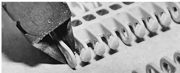
Figur 26: Klipp av den yttersta länken
