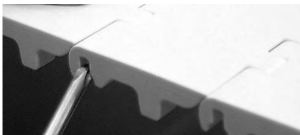
Figur 204: Tryck pinnen förbi spärranordningen
