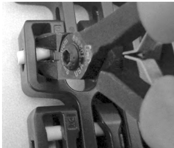
Figur 316: Tryck pinnen åt sidan och förbi hålet
